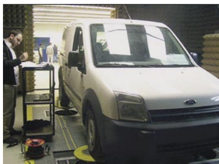
▲ 四柱式試験装置上でテスト中のセミアクティブサスペンションコントローラ付きの Ford Transit Connect
